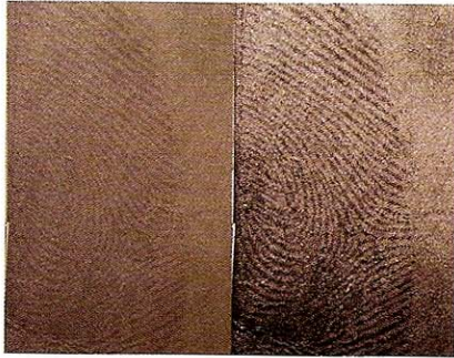
Figure 10 : À gauche, photo originale d'une partie d'empreinte traitée avec la séquence ORO-RP. À droite, la même photo suite à l'amélioration du contraste à l'aide d'Adobe Photoshop CS2.
